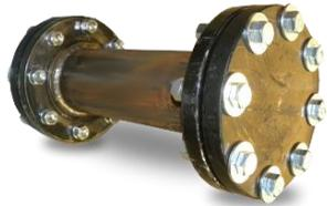
13. Des essais ont été effectués sur l'emballage prévu dans le permis spécial DOT-SP 13481, troisième révision, pour vérifier que la mise à feu de 25 grammes de liquide ne provoquait pas la rupture du tube. Pour l'essai, 25 grammes de nitroglycérine ont été placés à l'intérieur du tube ainsi qu'un détonateur. Aucun effet dangereux n'a été observé à l'extérieur du tube, qui était parfaitement intact. On trouvera ci-dessous une photo du tube à l'issue de l'essai.
