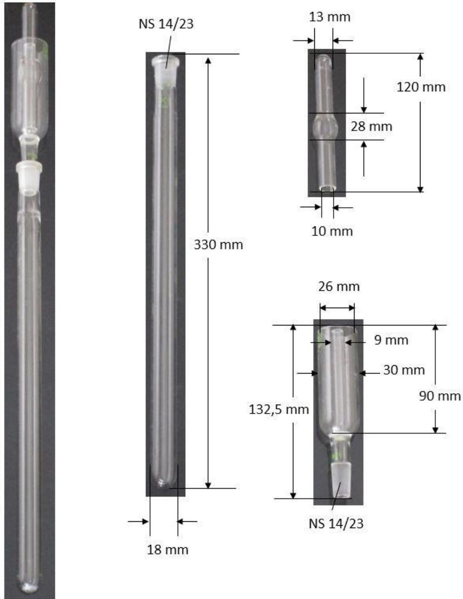
Figure A10.2 : Chambre de condensation pour l'épreuve de Bergmann-Junk (exemple 2)
