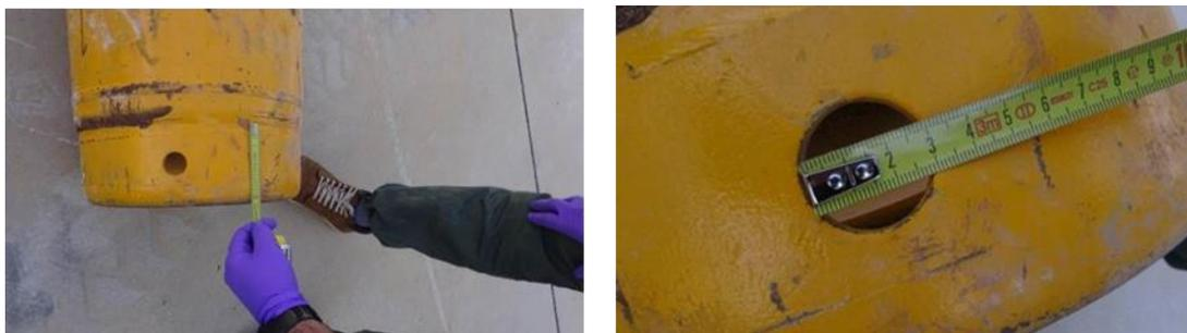
5.48 En la parte superior de cada bombona, se veía todavía la cavidad de la válvula, con dimensiones aproximadas de 70 mm de diámetro y 20 mm de altura.
