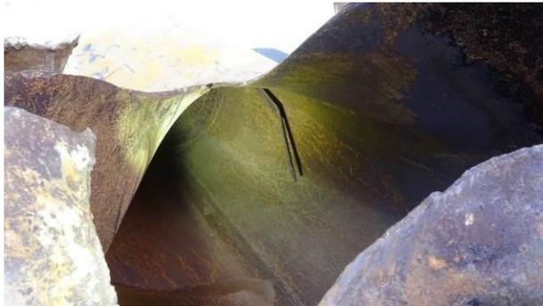
5.47 La base exterior de la bombona tenía soldado un aro de soporte. El diámetro del aro de la base era de 330 mm y la altura de 100 mm aproximadamente. En la base había cuatro agujeros con un diámetro aproximado de 30 mm.
