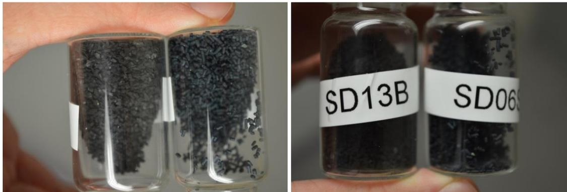
Apariencia distinta del carbón vegetal en la muestra en blanco SD13B (a la izquierda en las dos fotografías) y en la muestra real SD06S (a la derecha en las dos fotografías)
