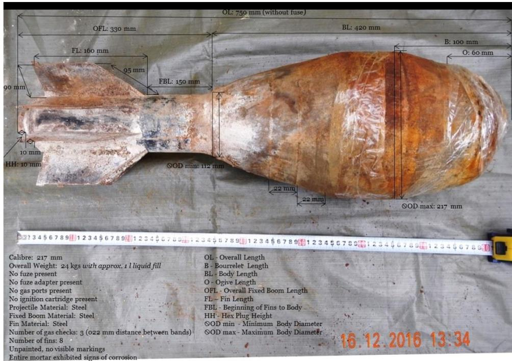
Imagen n.º 9: Fotografía del mortero en la que figuran sus dimensiones y una descripción.
