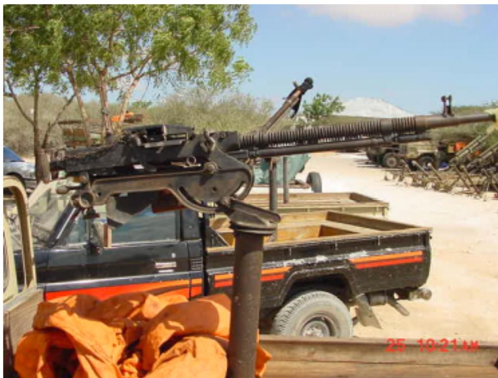
Тяжелый пулемет ДШК, установленный на пикапе (на заднем плане видно другое оружие).
