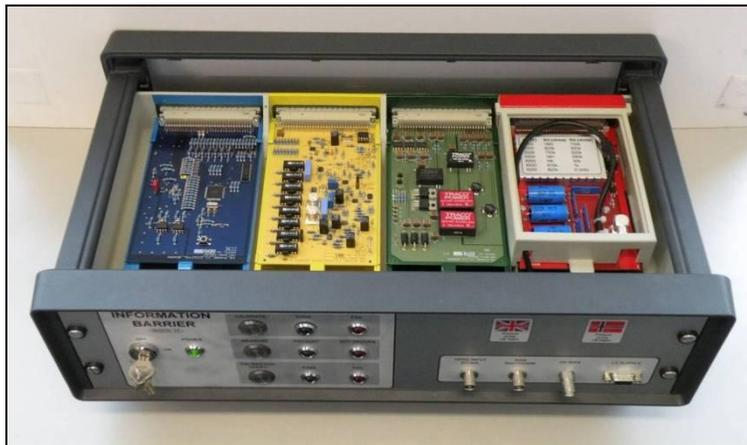
*Figura 2. Protección de datos mediante filtros de la iniciativa del Reino Unido y Noruega. Un detector externo de rayos gamma se conecta al sistema.*
