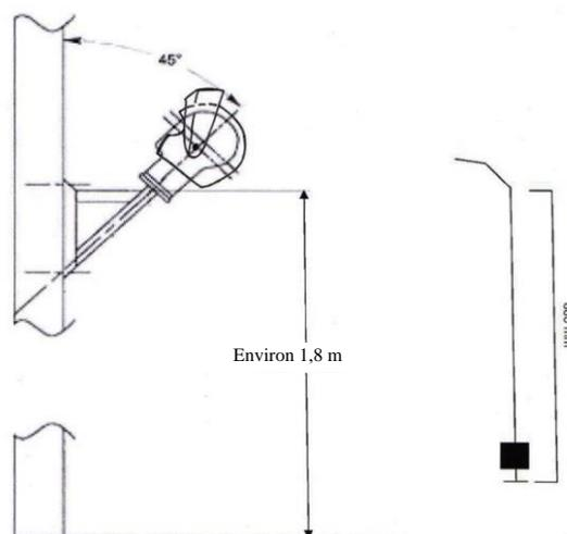
L'appareillage d'essai doit permettre à une masse tombante d'effectuer une chute libre guidée jusqu'à heurter une enclume rigide. La masse du système de guidage doit être de  $1,0 (-0,0/+0,2)$  kg. Le système de guidage doit être conçu de telle manière que la vitesse d'impact ne soit pas inférieure à 95 % de la vitesse théorique.
