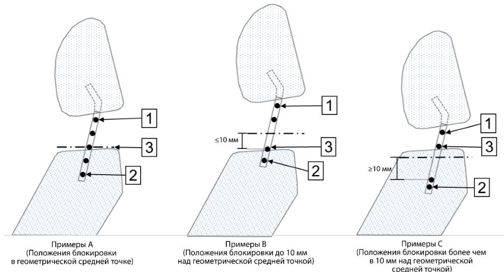
Если подголовник предусматривает регулировку в переднем–заднем направлении с возможностью блокировки, то его устанавливают в положение, соответствующее средней точке. При наличии положения блокировки в пределах 10 мм вперед по горизонтали от геометрического среднего положения его принимают за испытательное положение. Если же положения блокировки в пределах 10 мм вперед по горизонтали от геометрического среднего положения не существует, то за
