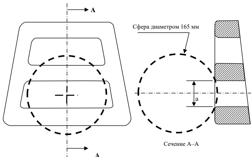
Примечание: Сечение А-А определяется в той точке поверхности, в которой сфера входит в проем на максимальную глубину без приложения какого-либо усилия.
