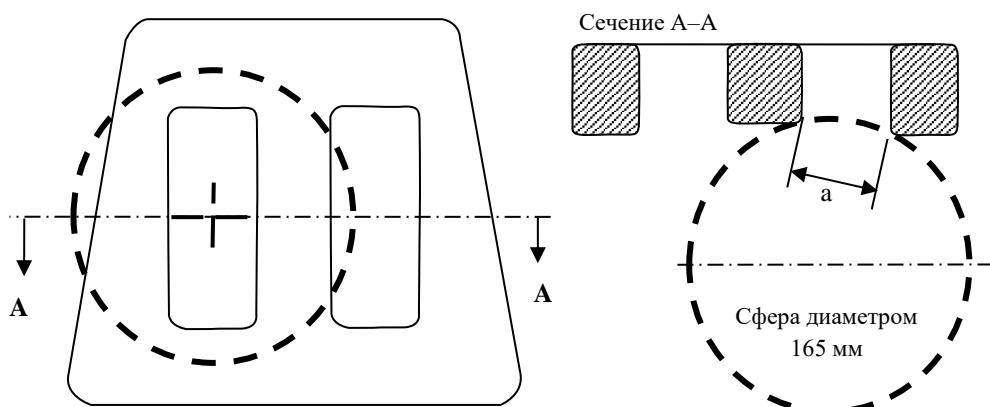
Примечание: Сечение А-А определяется в той точке поверхности, в которой сфера входит в проем на максимальную глубину без приложения какого-либо усилия.
