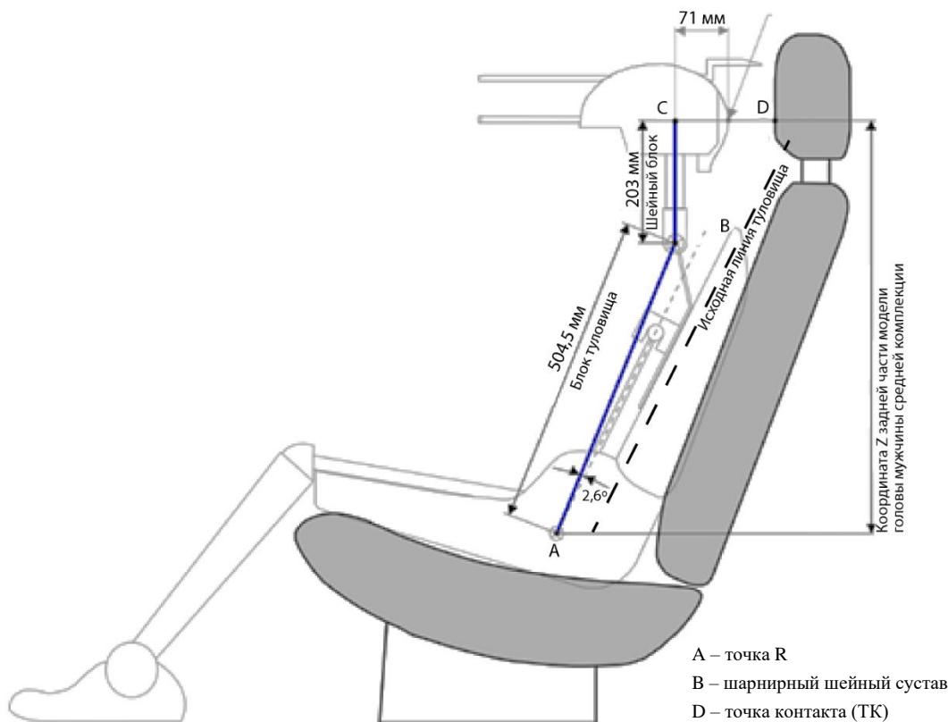
Механизм определения точки Н показан только для разъяснения концепции, но для данной процедуры испытания не требуется.
