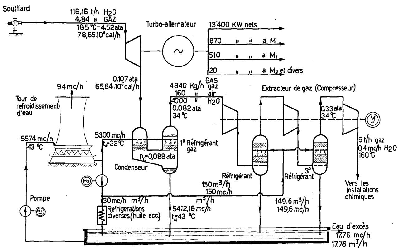
Figure 3. Installation à vapeur naturelle, à condensation (schéma 3)
