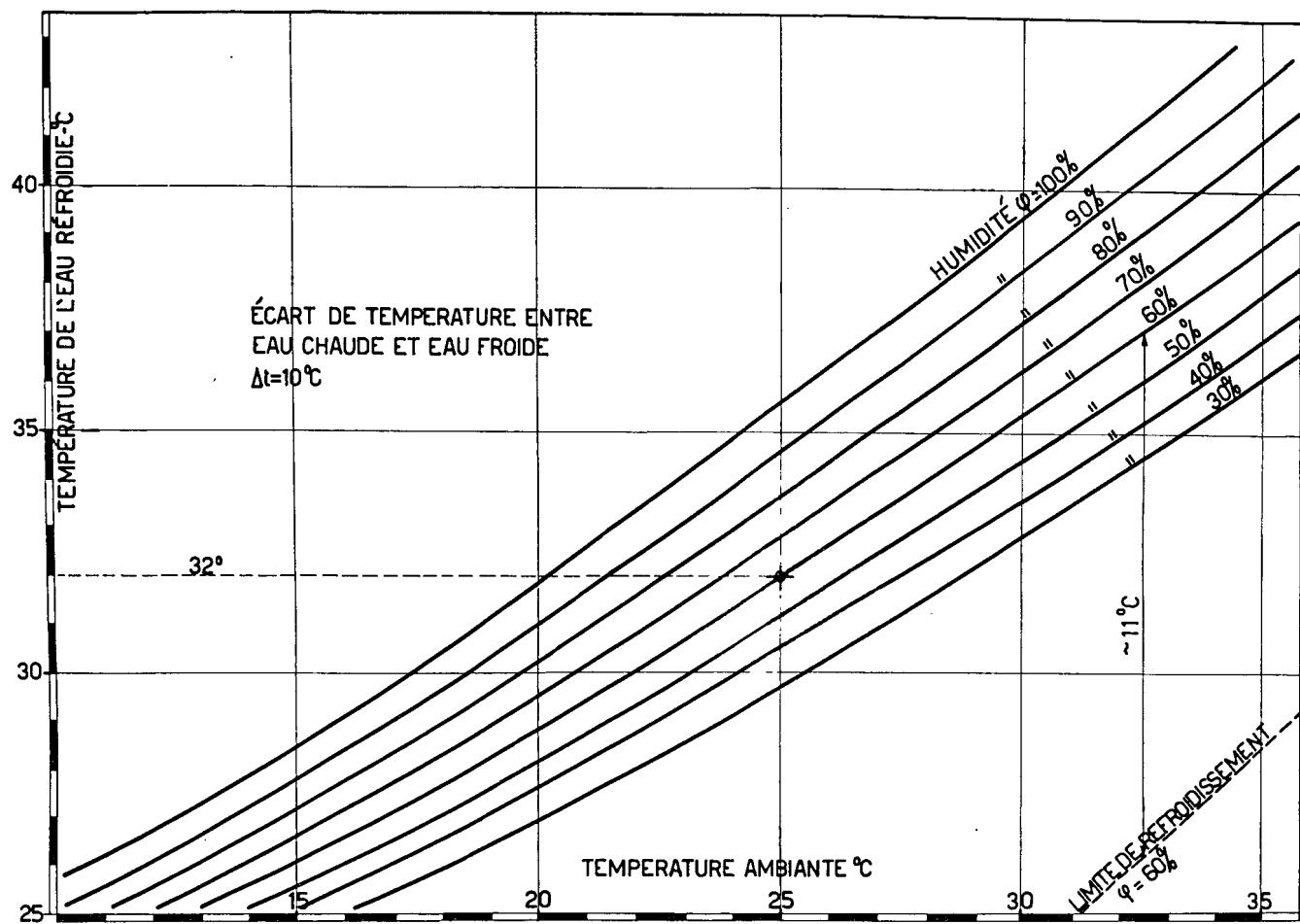
Figure 9. Tour hyperbolique de 9 000 m<sup>3</sup>/h : diagramme de refroidissement
