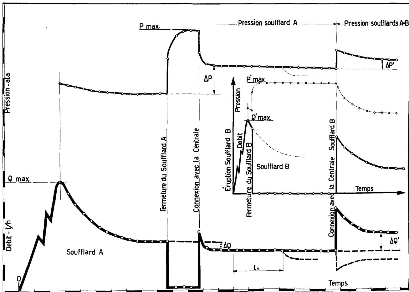
Figure 14. Exploitation des soufflards munis d'appareils de fermeture
