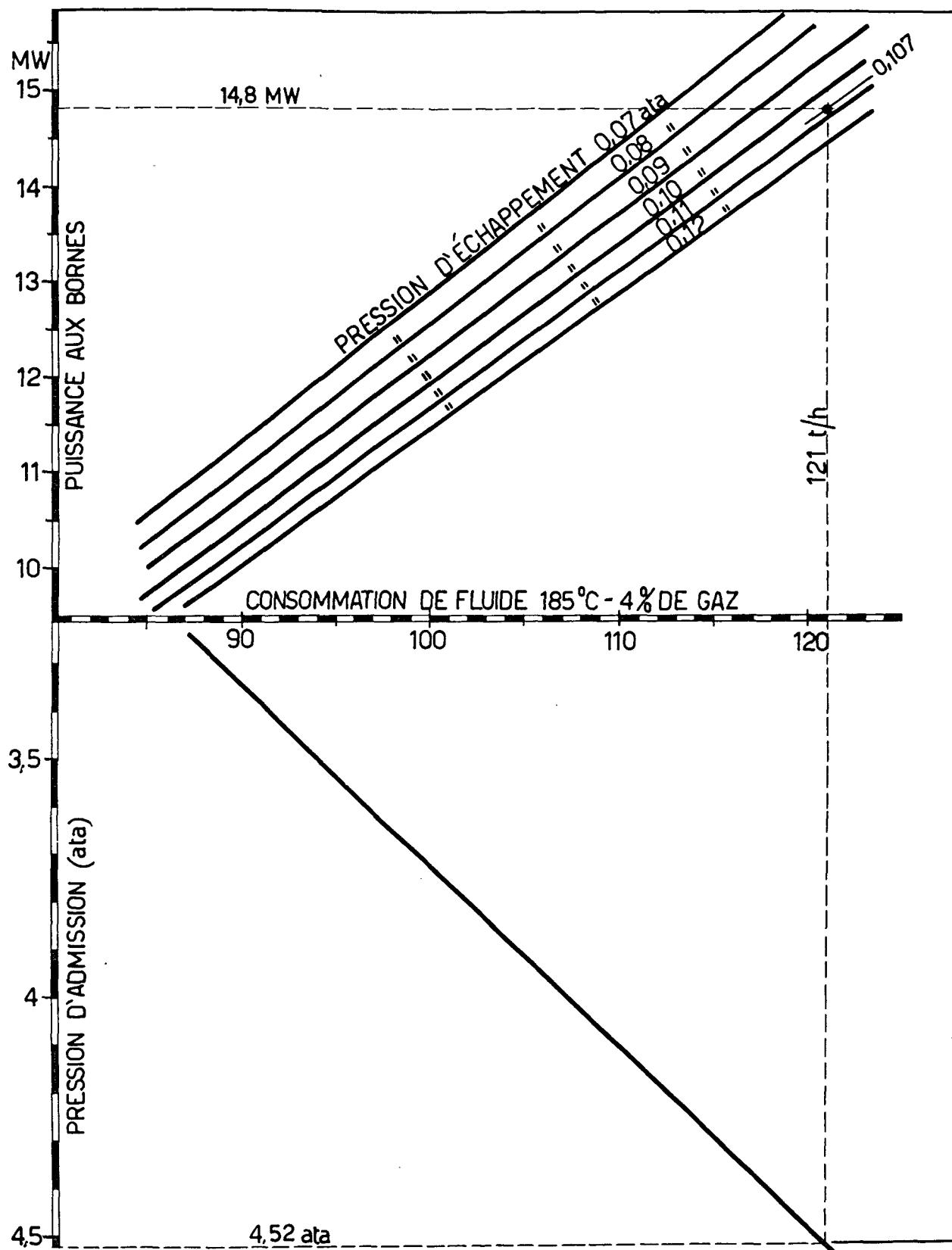
Figure 8. Caractéristiques de consommation, groupe de 15 000 kW (voir schéma 3)
