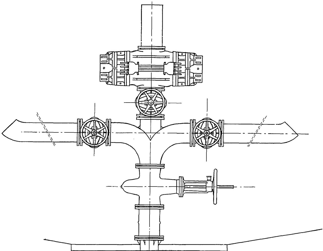
**Figure 2. Arbre de Noël avec vanne centrale et dispositif de protection dans un puits d'exploitation de vapeur naturelle**
