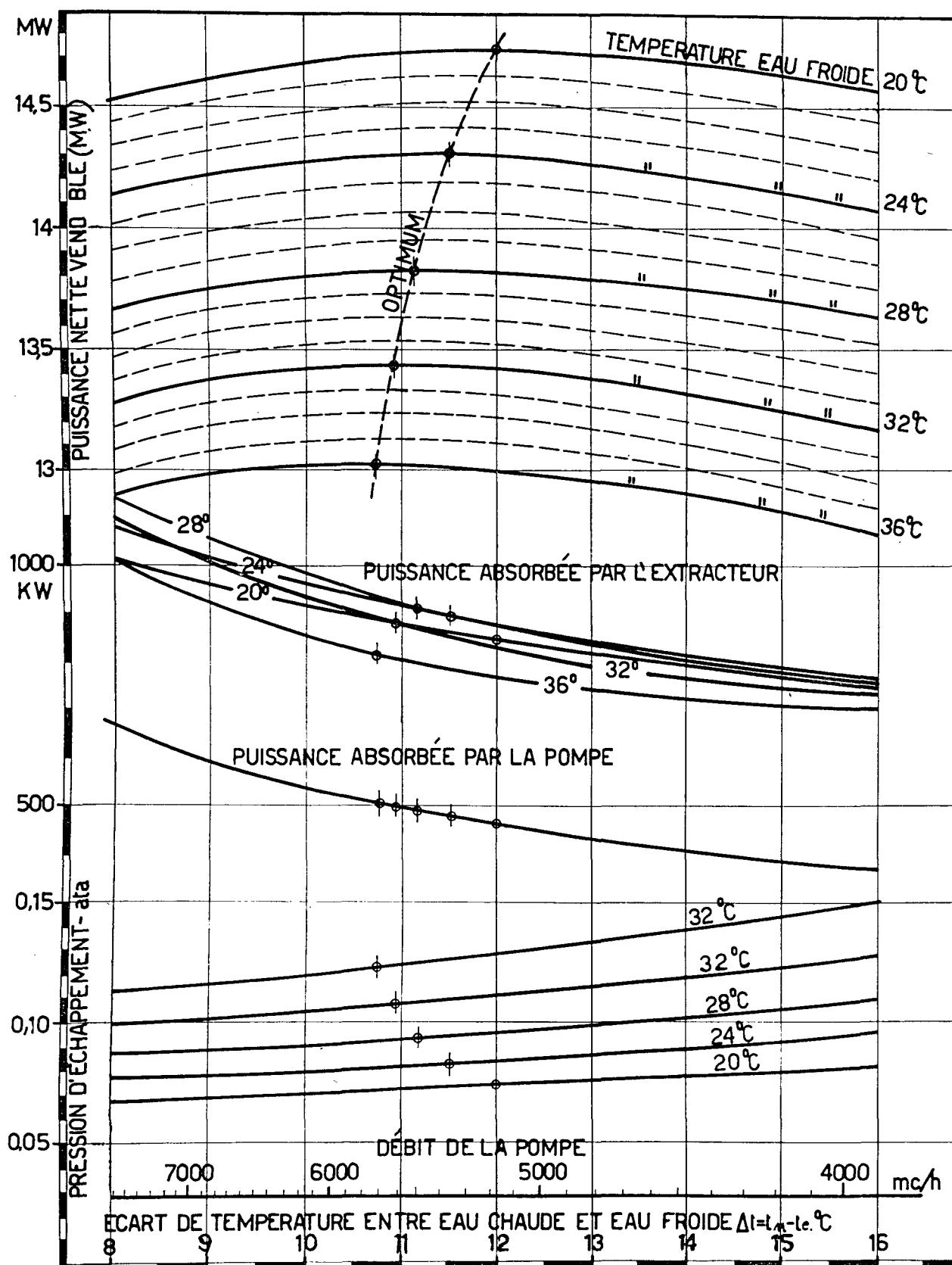
Figure 11. Recherche de l'optimum pour les auxiliaires d'un groupe à vapeur naturelle
