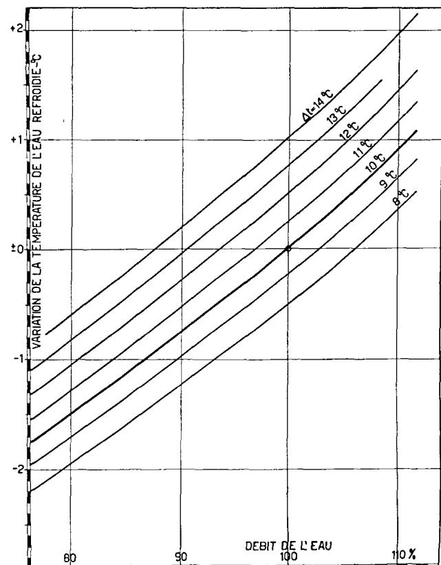
Figure 10. Courbes de correction pour la figure 9
