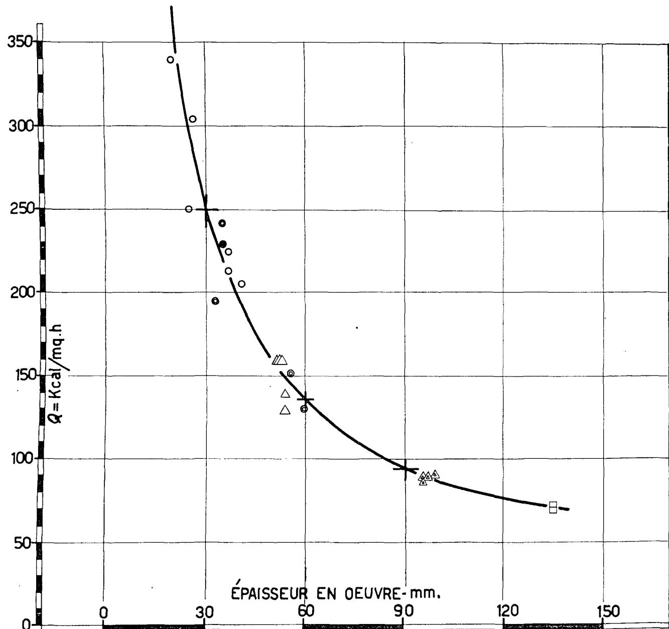
Figure 15. Coefficient total de transmission pour les isolants thermiques
