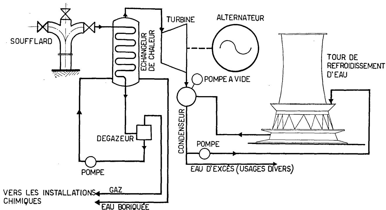
Figure 2. Installation à vapeur pure, à condensation (schéma 2)
