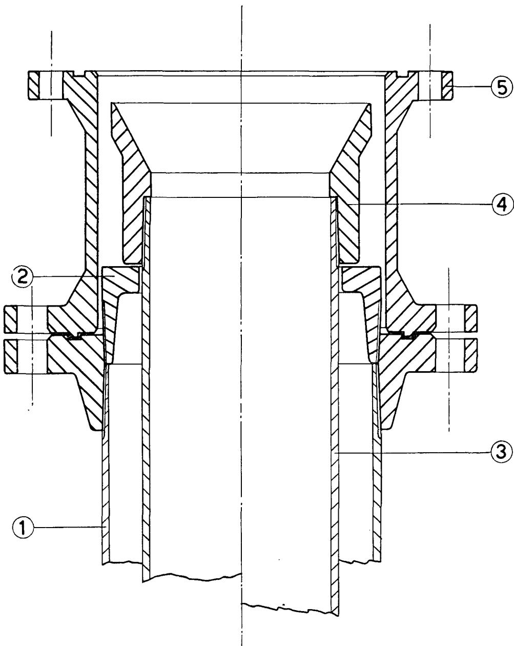
Figure 1. Tête de tubage dans un puits d'exploitation de vapeur naturelle
