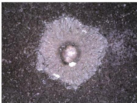
在载人 4 号航天器的反应控制系统发动机喷嘴上观察到的撞击。放大率：59.3×。
