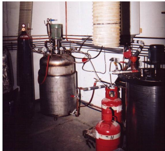
L'autoclave (récipient sous pression) à l'arrière-plan avait une capacité de 240 litres. Au moment de la saisie, il était sous pression (3 bars), chauffé (à 80 °C), relié à deux bonbonnes de gaz (hydrogène et méthylamine) et rempli d'un mélange de MDMA (base), de méthanol et de 3,4-MDP-2-P.
